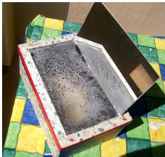
Il vapore acqueo che si forma sotto il vetro
