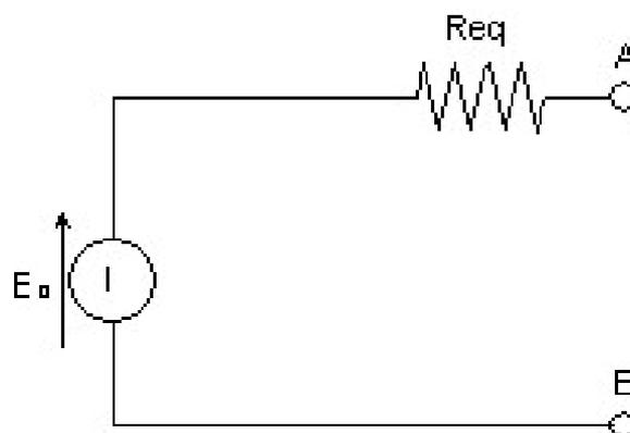
Fig.4.4 –Generatore equivalente di Thevenin.-
