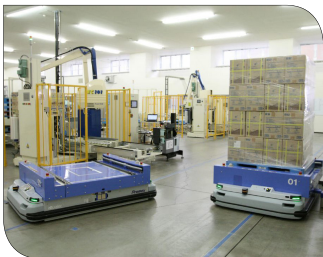
Figura 1a. AGV in movimento su nastro magnetico (Fonte: MURATA MACHINERY USA, INC.)
