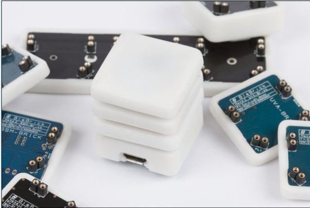
Il BLE-B base posto in cima ai mattoncini combinati
