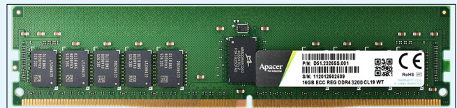
RDIMM Form Factor (Fonte: DDR4 RDIMM)
