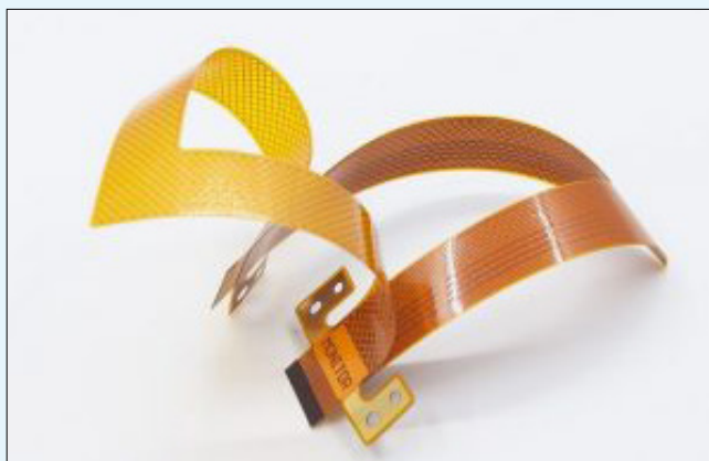
Figura 3: Esempio di PCB Flessibile (fonte: www.pcbway.com )
