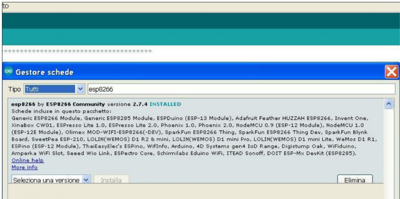
Figura 1: Installazione scheda ESP8266
