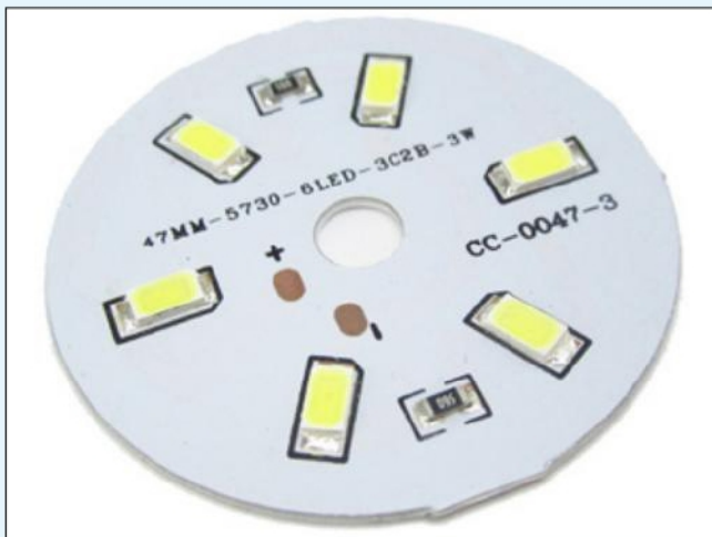
Figura 3: Circuito stampato in alluminio di una lampada a LED
