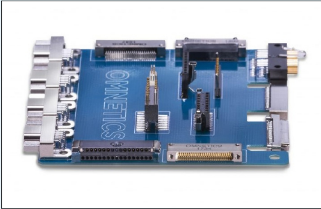
Figura 1: PCB board che include connettori Omnetics Micro e Nano Strips
