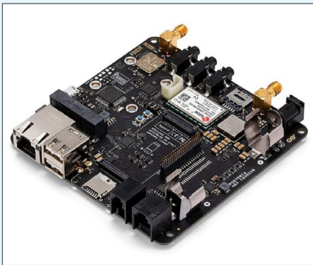
Figura 1: Arduino Portenta Max Carrier (Fonte: PORTENTA MAX CARRIER ARDUINO - Scheda prototipo | LoRa,LTE CAT 1; 6÷36VDC; 101,6x101,6mm; ABX00043 | TME - Componenti elettronici )
