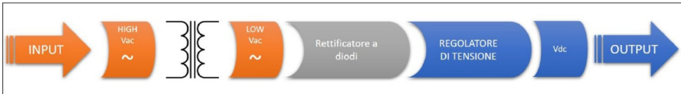
Figura 1: Diagramma a blocchi semplificato dell'architettura di un convertitore AC/DC lineare
