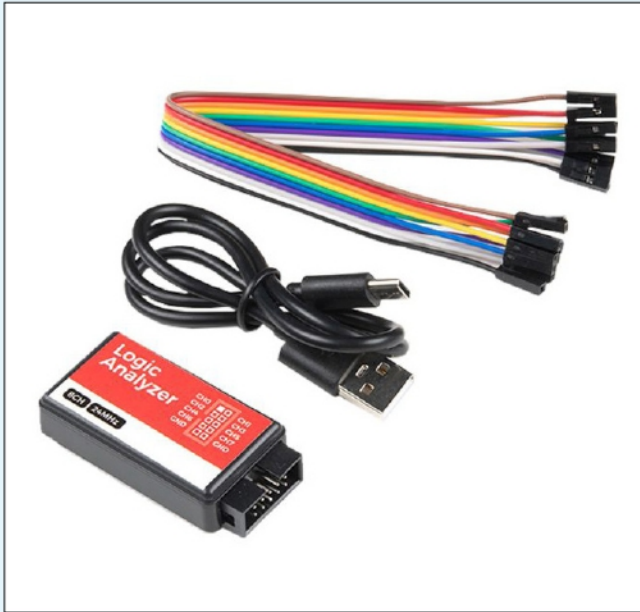
Figura 5: L'analizzatore logico a 8 canali/24 MHz basato su USB di SparkFun è in grado di effettuare in tempi brevi il debug di quasi tutti i tipi di interfacce seriali ed è disponibile a un prezzo estremamente contenuto
