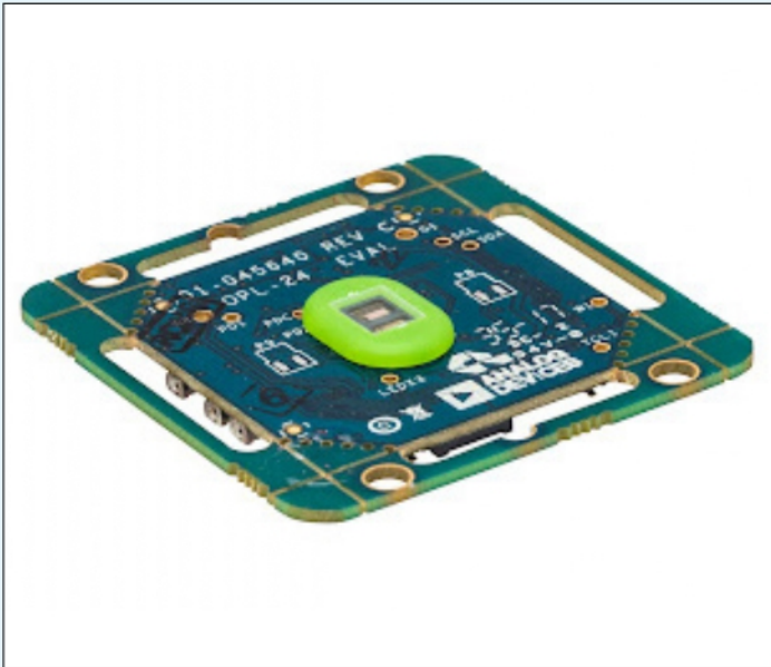
Figura 2: La scheda di valutazione EVAL-ADPD188GGZ per applicazioni PPG di Analog Devices (Fonte: Analog Devices)
