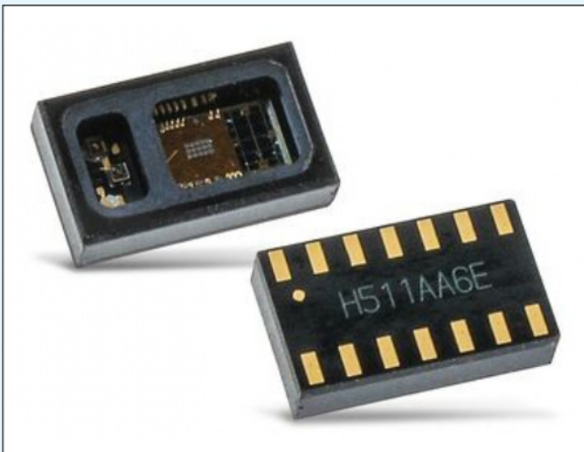
Figura 3: Il sensore ottico MAX30102 di Analog Devices/Maxim Integrated (Fonte: Mouser Electronics)
