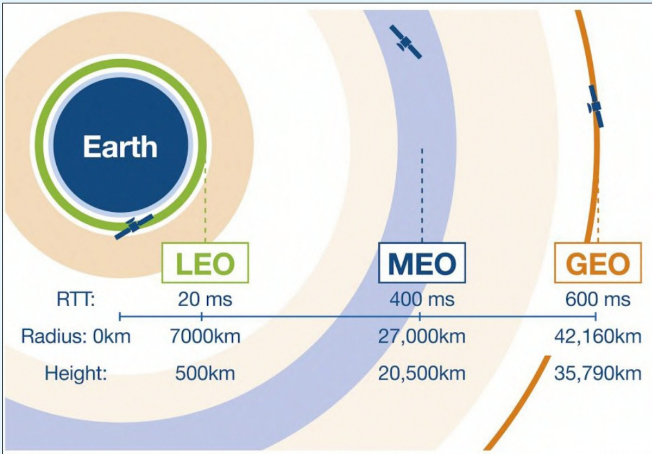
Figura 1: La posizione delle tre orbite - GEO, MEO e LEO - rispetto alla Terra con l'indicazione delle rispettive distanze e della latenza del segnale di andata e ritorno (Fonte: Mouser)
