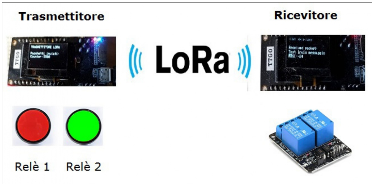
Figura 1: Schema di principio del sistema di monitoraggio e controllo remoto delle utenze elettriche
