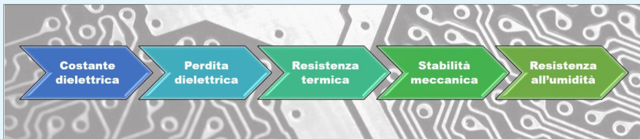
Figura 1: Proprietà fondamentali dei materiali per PCB
